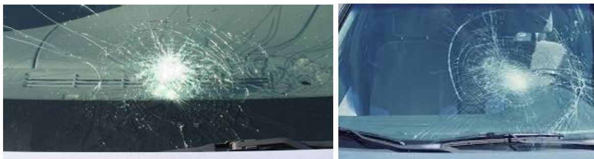
Fig. n.10 – Esempi classici di rottura di un vetro per effetto di una sollecitazione meccanica
