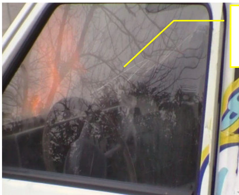
Fig. n. 55 – Fermo immagine delle riprese video – rottura del lunotto anteriore
