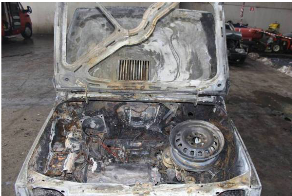
Fig. n.50 – Segni lasciati dall'incendio all'interno del vano motore
