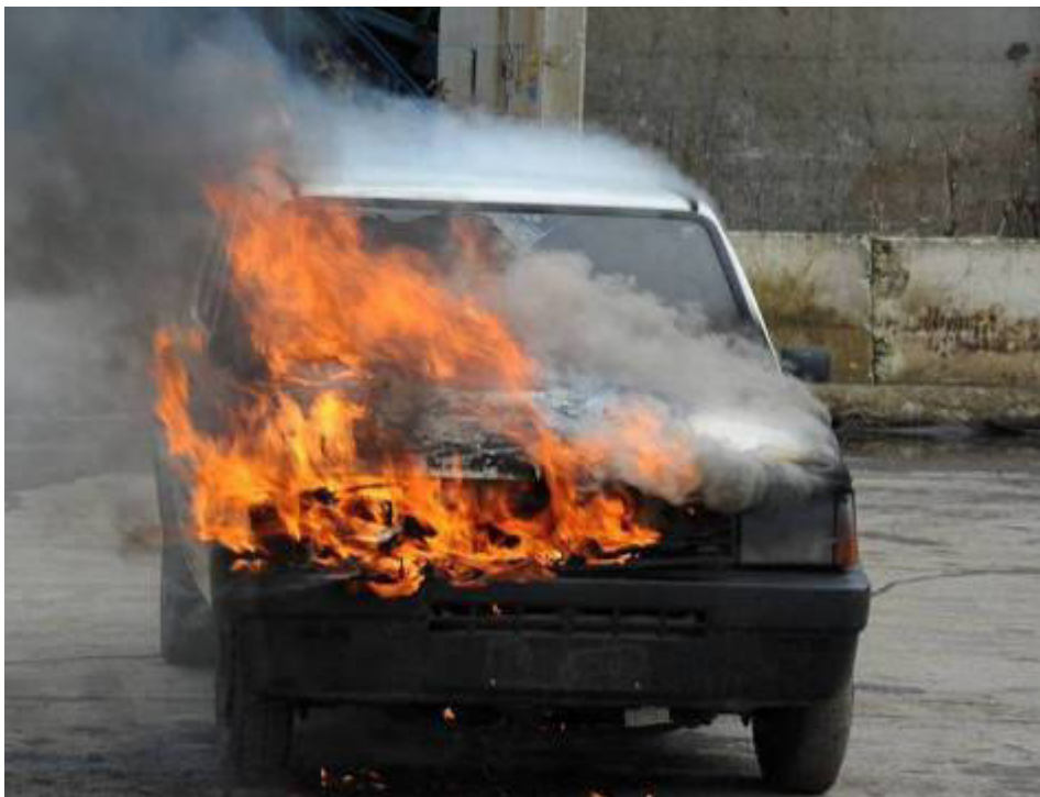
Fig. n.36 – Incendio del vano motore dopo 11'
