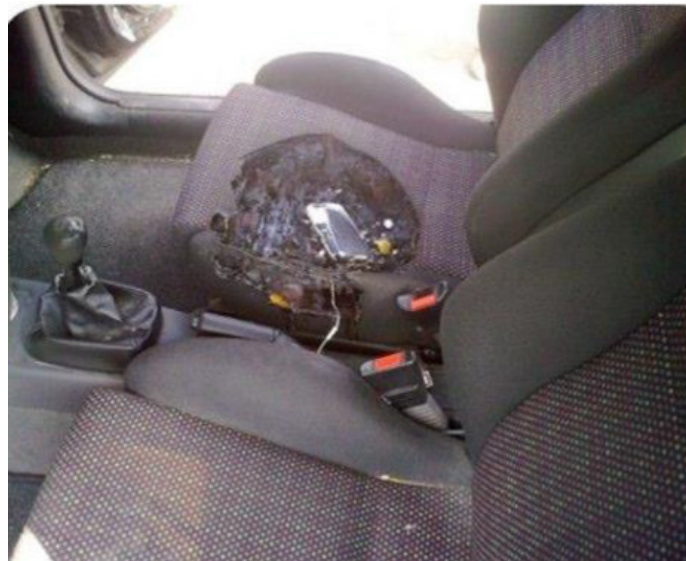
Fig. n.5 – Segni di danno su un sedile anteriore lasciati da un apparecchio elettrico posto in carica.
