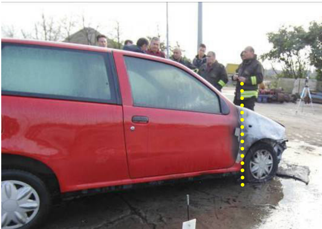
Fig. n.64 – Danneggiamento del vano motore
