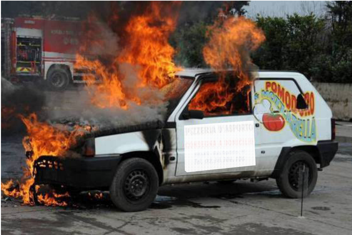
Fig. n.37 – Incendio del vano motore e vano abitacolo dopo ~ 14'
