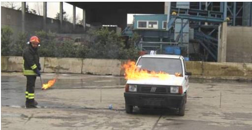
Fig. n.31 – Innesco dei vapori di benzina dalla presa d'aria del cofano motore
