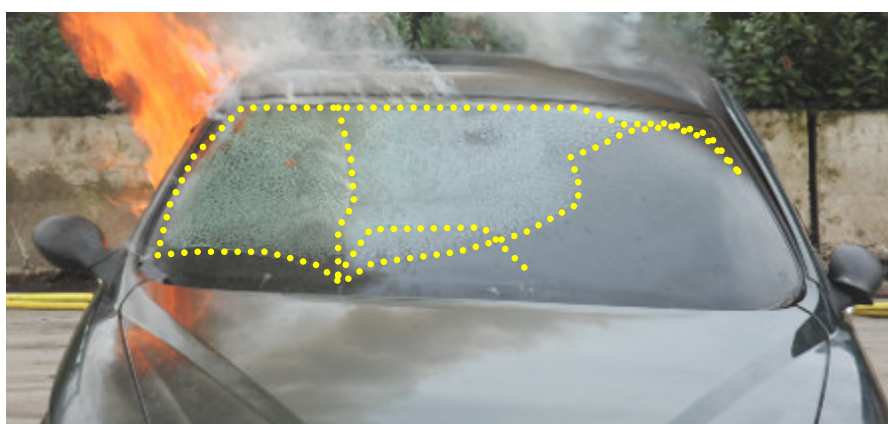
Fig. n.13 – Rottura di un parabrezza per effetto di una sollecitazione termica
