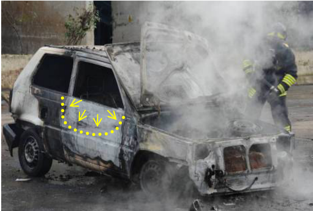
Fig. n. 54 – Danno prodotto dall'incendio sulla portiera lato passeggero
