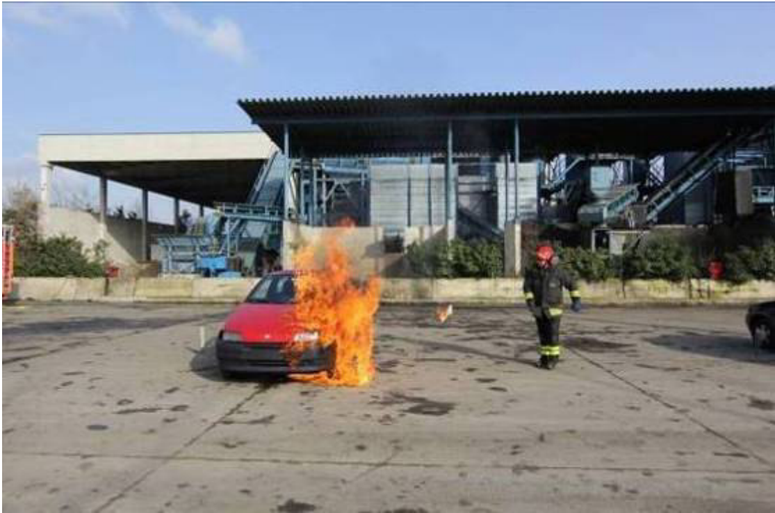
Fig. 57: Innesco dei vapori di liquido accelerante
