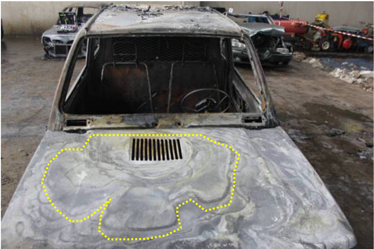
Fig. n.47 – Segni lasciati dall'incendio sul cofano motore
