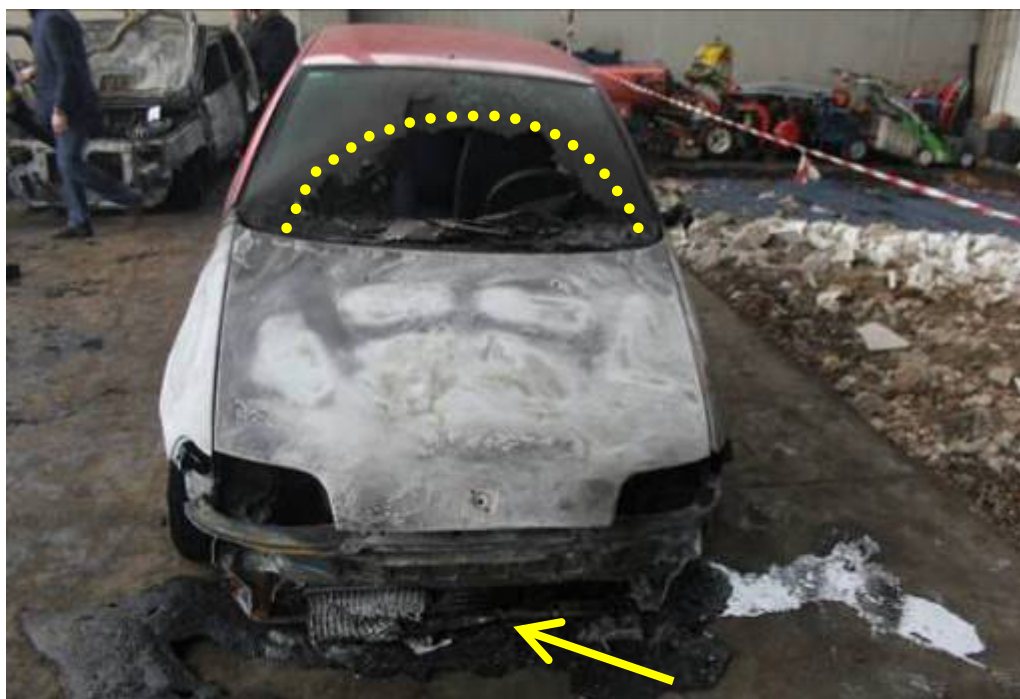
Fig. n.65 - Tipologia di danno del parabrezza
