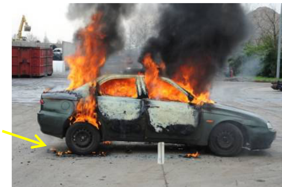
Fig. n.22 – Innesco pneumatici posteriori
