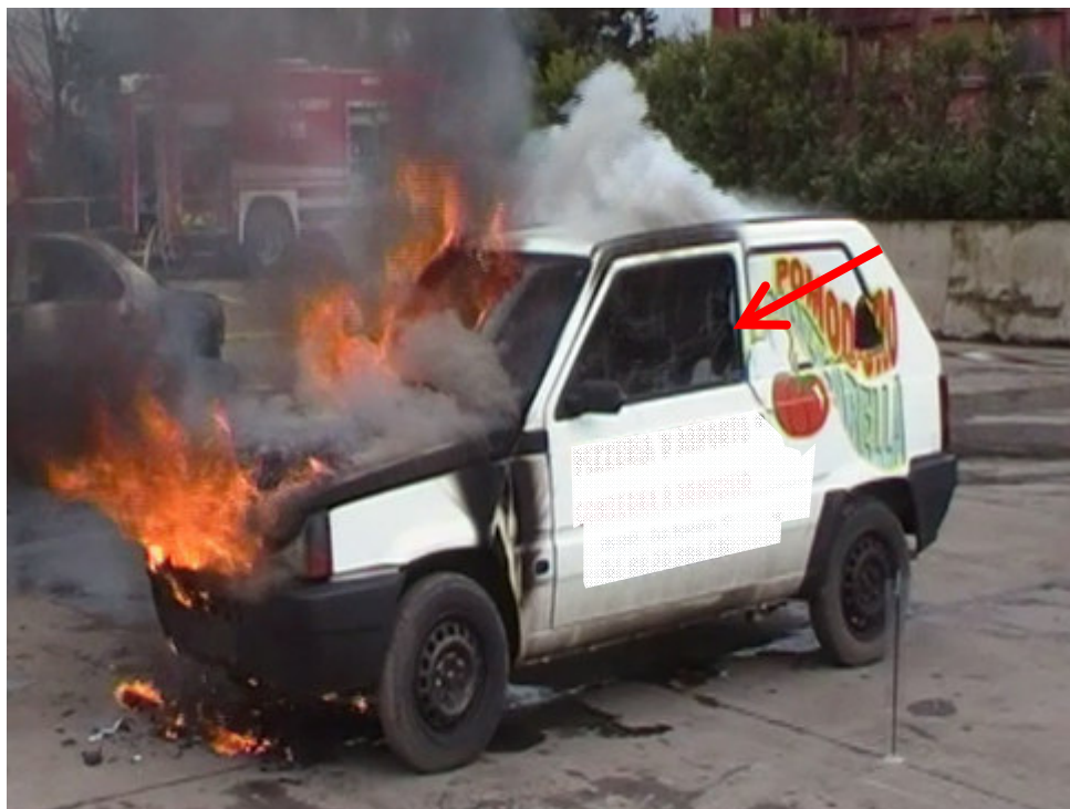
Fig. n.42 – Rottura del vetro anteriore lato guida
