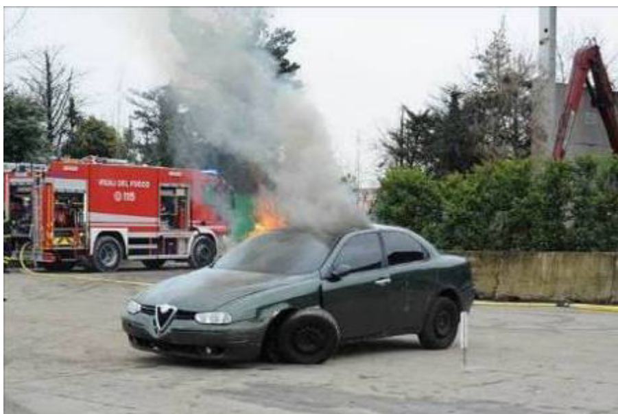
Fig. n. 16 – Fuoriuscita dei prodotti di combustione dalla portiera anteriore sinistra
