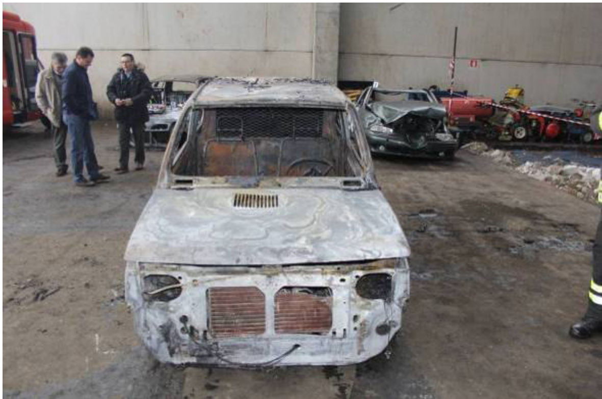
Fig. n.45 – Vista frontale vano motore
