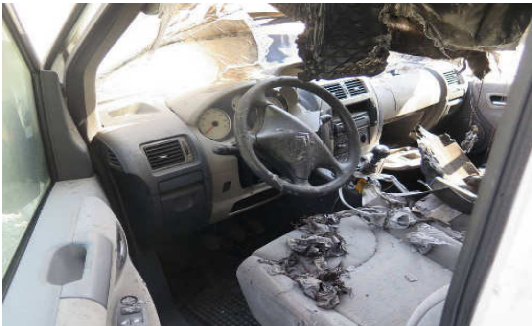
Fig. n.1 - Vista interno abitacolo, gocciolamento dei materiali del tettuccio
