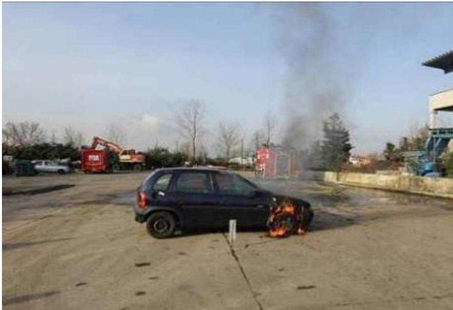
Fig. 70: Le fiamme attaccano la vernice del parafrangente e fuoriesce fumo dall'abitacolo
