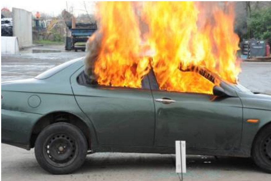
Fig. n.19 – Incendio generalizzato nell'abitacolo
