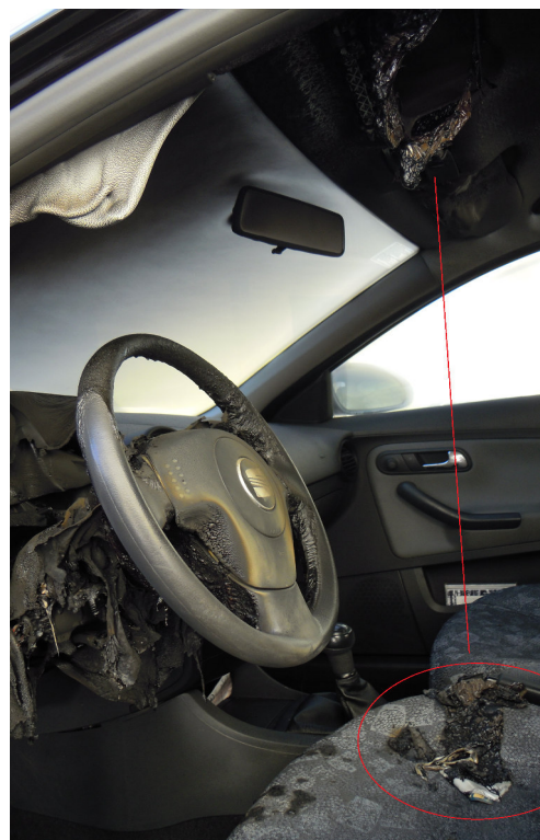
Fig. nn. 8 e 9 - Effetto gocciolamento materiale plastico
