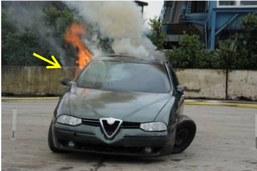
Fig. n.18 – Rottura del finestrino posteriore destro
