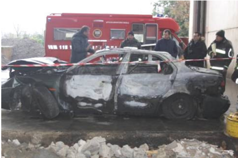
Fig. n.24 – Danneggiamento lato sinistro (lato guida)
