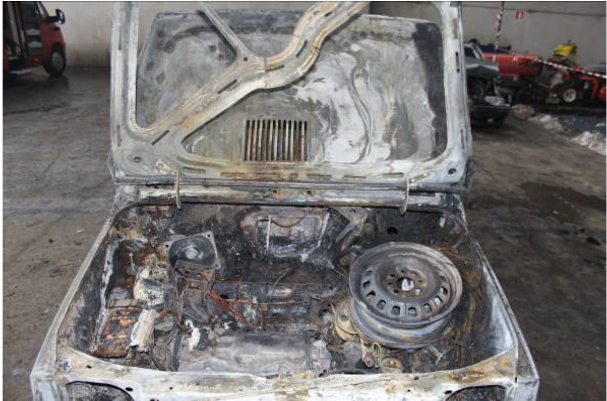
Fig. n.48 – Danneggiamento della ruota di scorta posizionata nel vano motore
