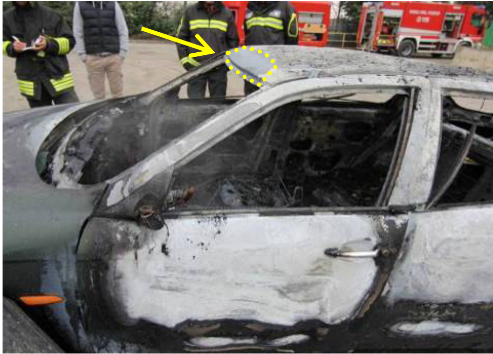
Fig. n.29 – Danneggiamento tettuccio auto
