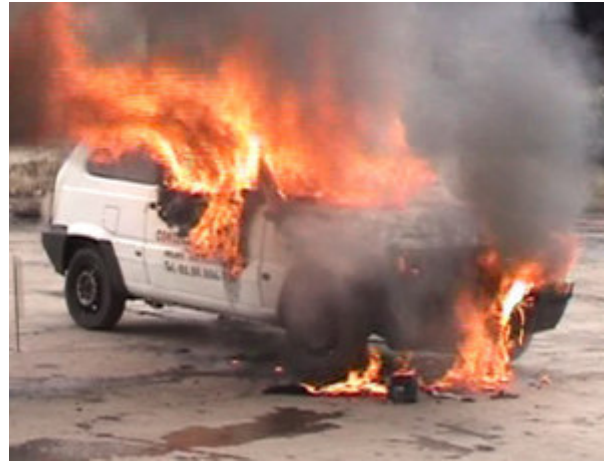
Fig. n.39 - Fermo immagini della ripresa video dopo circa 16'÷17' dall'inizio prova che illustrano la progressione dell'incendio sullo strato di verniciatura della portiera, dall'alto verso il basso
