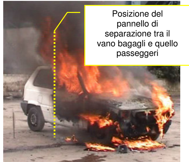
Fermo immagine dell'incendio dopo ~ 20'
