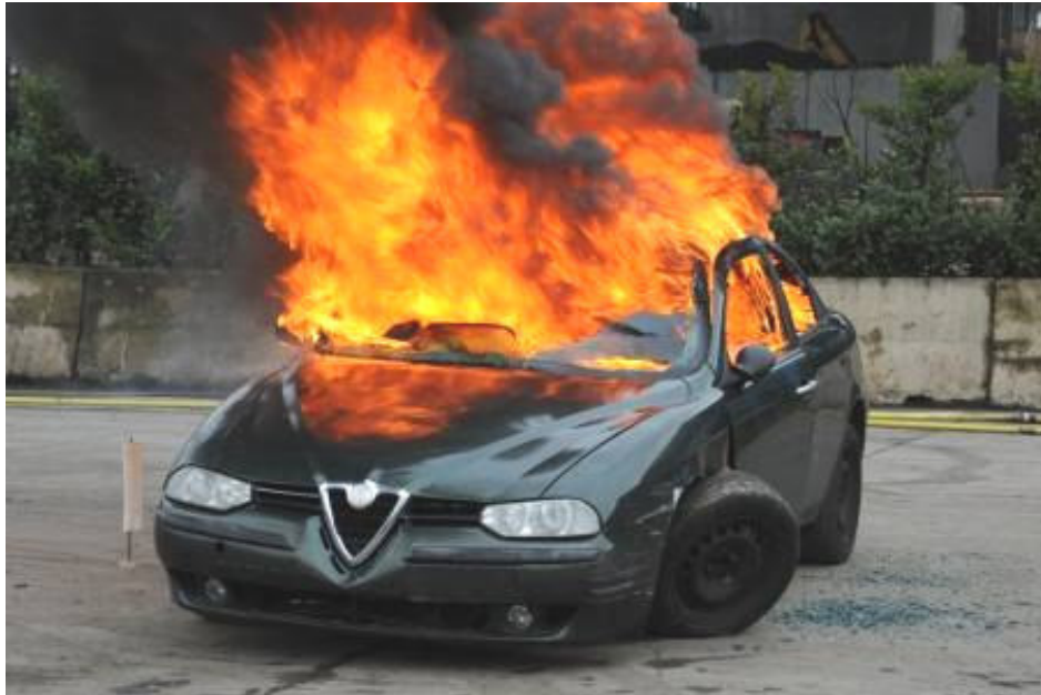
Fig. n.20 – Rottura del lunotto anteriore e dei finestrini lato guida
