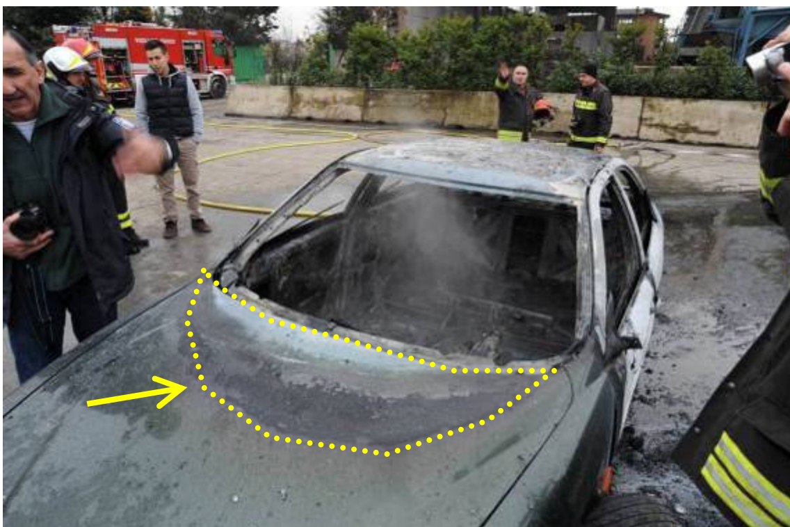
Fig. n.26 – Danneggiamento portello vano motore
