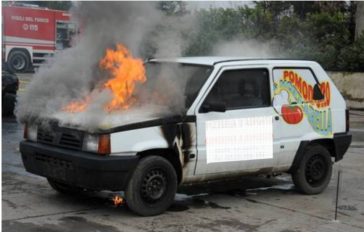
Fig. n.35 – Incendio del vano motore dopo 7'
