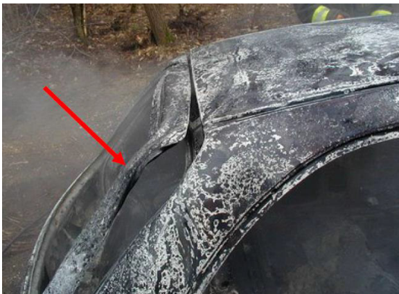
(Fig. n.91) deformazioni da scoppio di pistoni pneumatici
