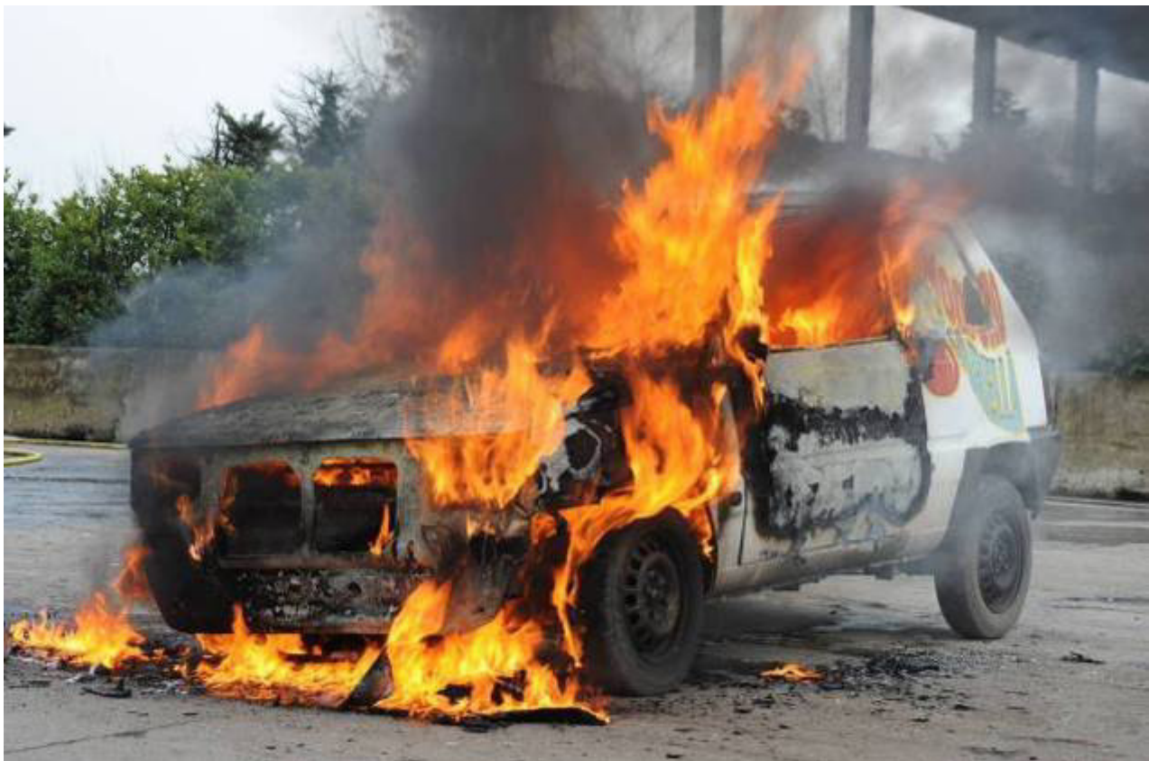
Fig. n.40 – Incendio dei pneumatici anteriori destro e sinistro dopo ~ 17' ÷ 23'
