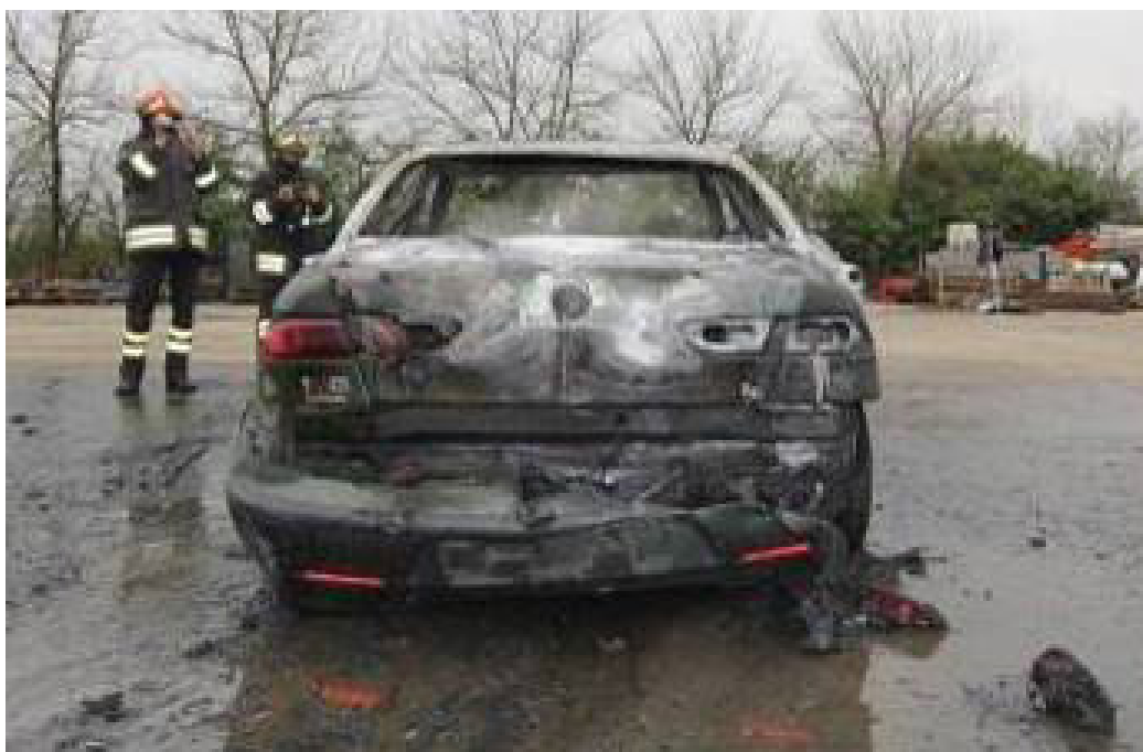
Fig. n.27 – Danneggiamento portello vano bagagliaio
