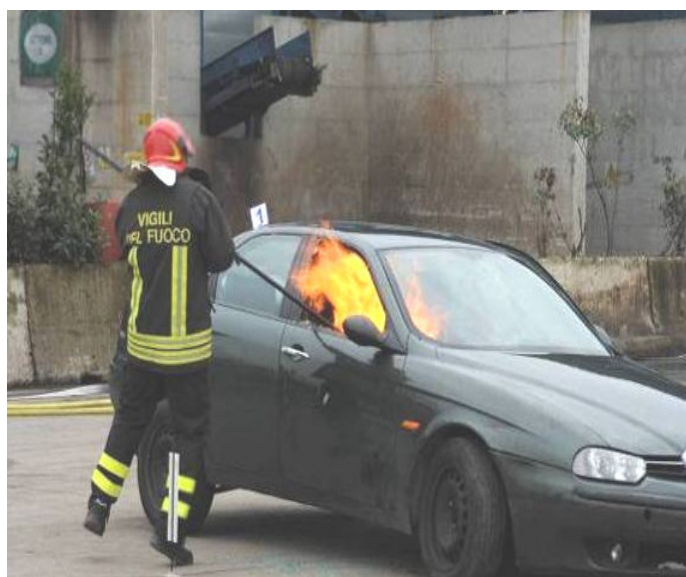
Fig. n.15 – Innescò dei vapori di benzina dal finestrino anteriore destro
