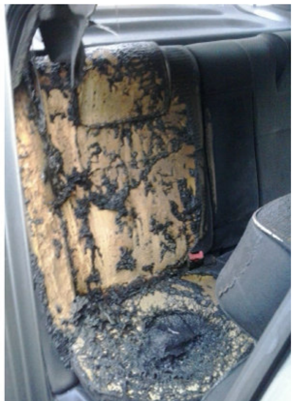
Fig. n.6 – Segni di danno su un sedile posteriore lasciati dall'accensione di una diavolina
