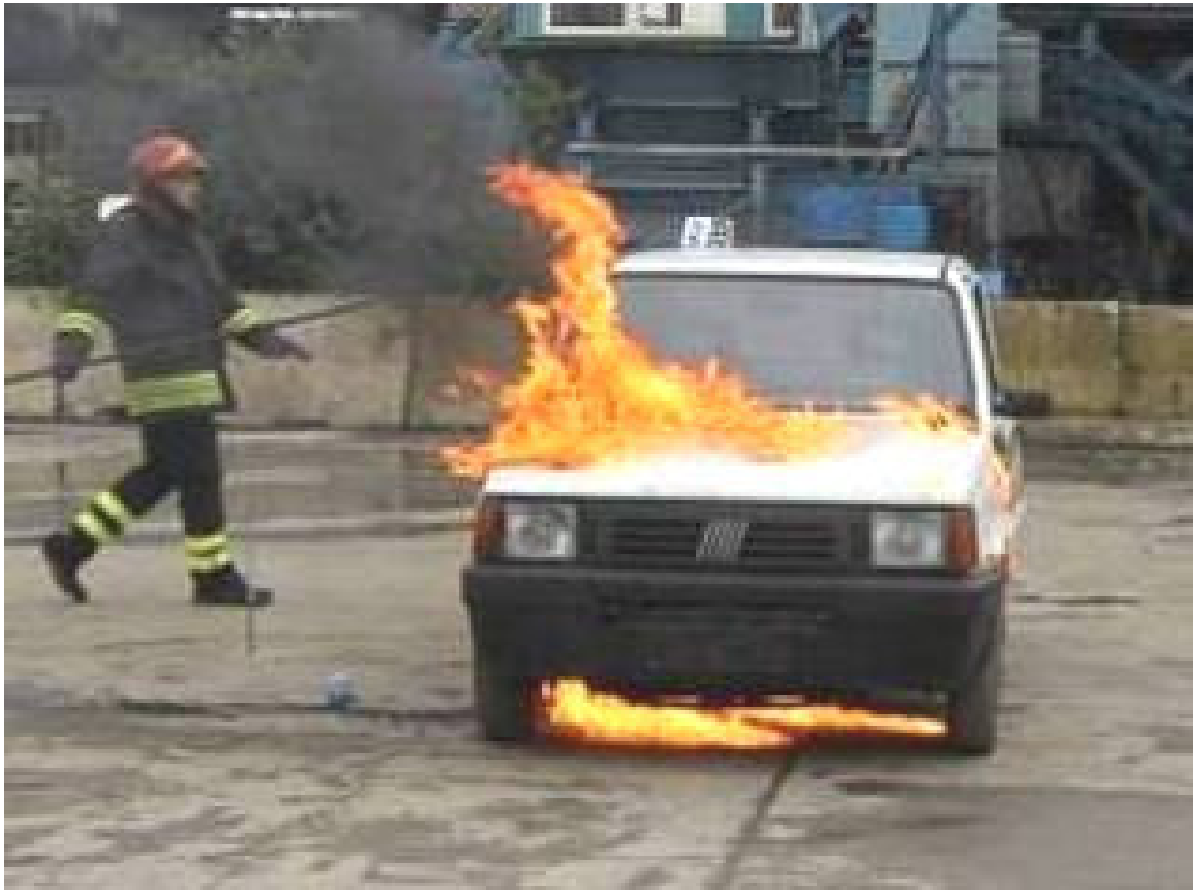
Fig. n.32 – Innesco dei vapori di benzina
