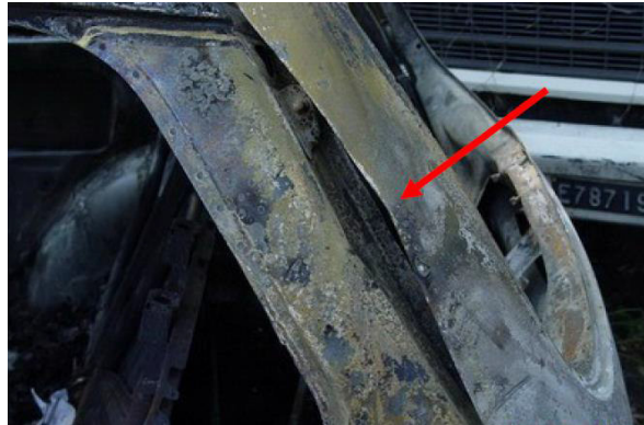
(Fig. n.90) deformazioni da scoppio di pistoni pneumatici
