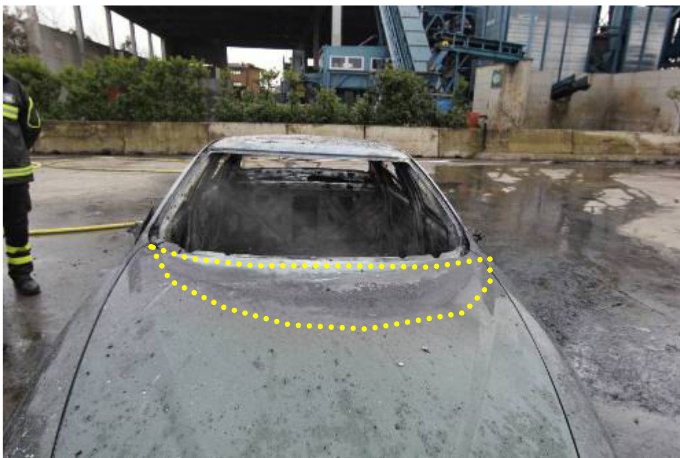
Foto n.16 – danneggiamento portello vano motore
