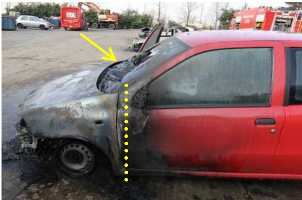
Fig. n.62 – Rottura del vetro del parabrezza
