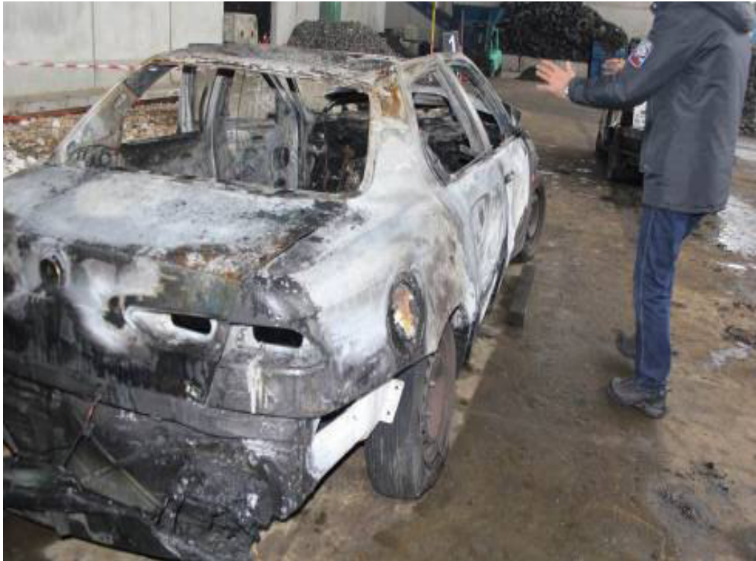
Fig. n.28 – Danneggiamento portello vano bagagliaio
