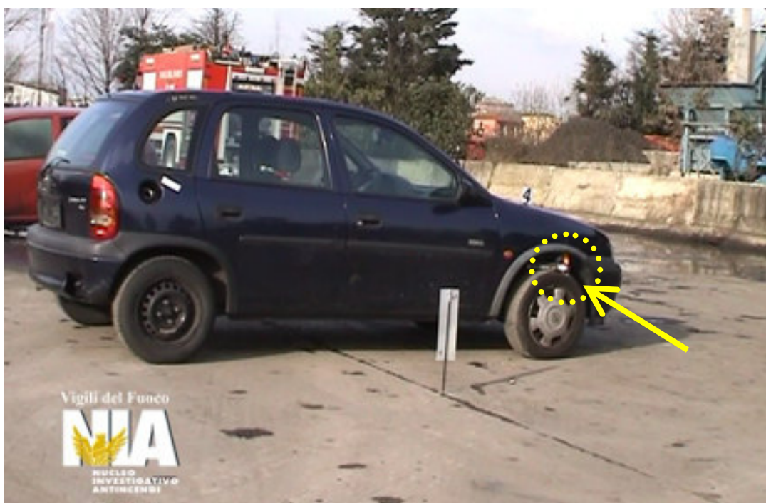
Fig. 68 – Innesco della ruota anteriore destra con diabolina
