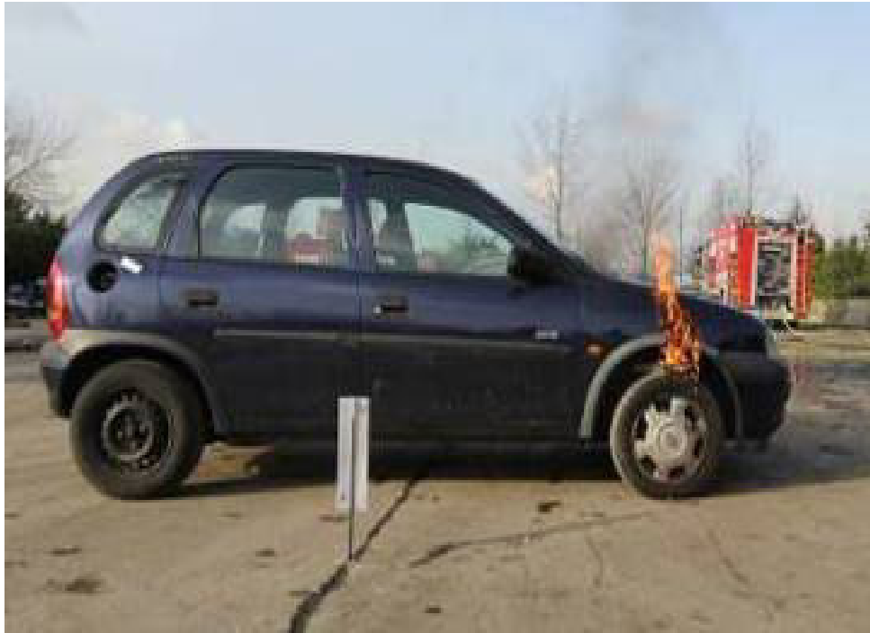
Fig. 69 – Inizio fuoriuscita fumo dal cofano motore
