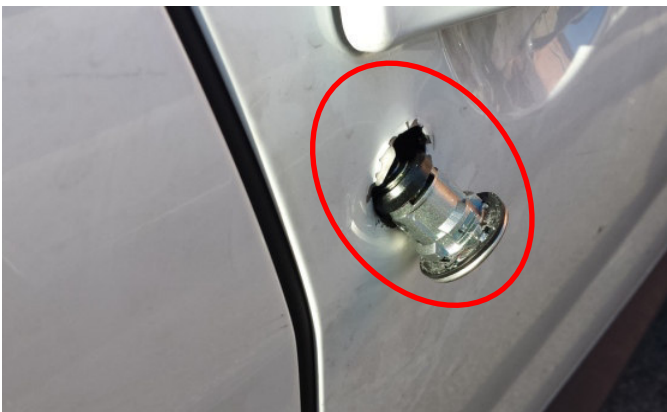
Fig. n.89 forzatura della serratura
