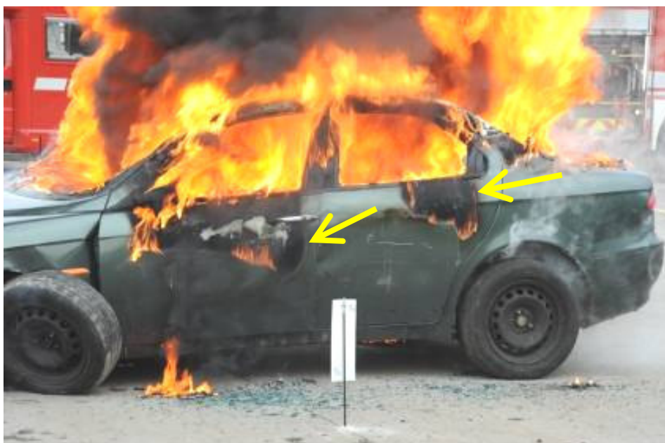
Fig. n.21 – Innesco vernice portiera lato guida e vano bagagli
