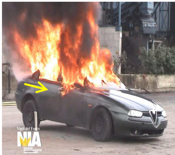
Fig. n.21 – Fermo immagine delle riprese video – incendio portiera anteriore lato dx
