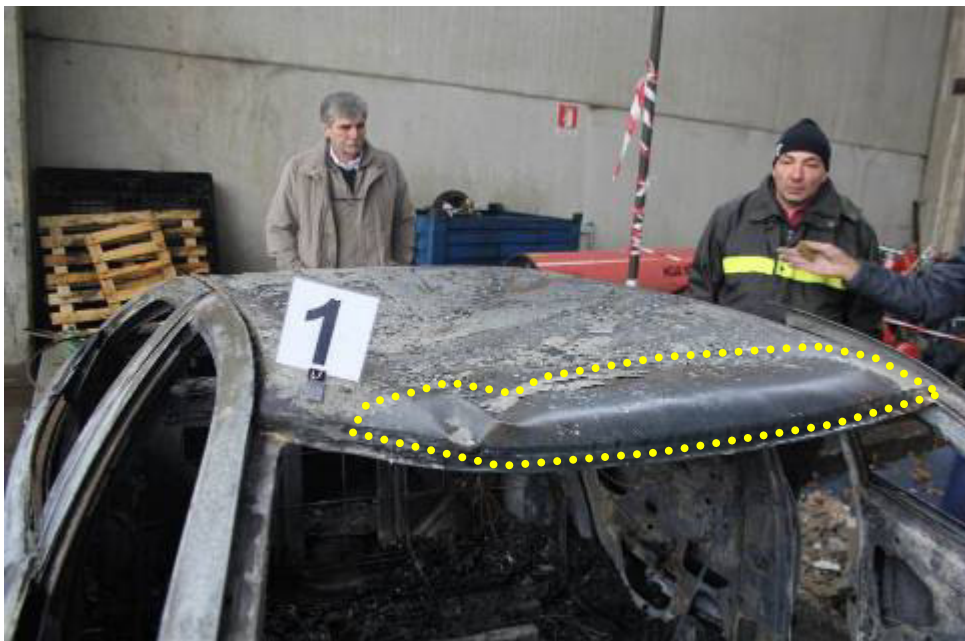
Fig. n.30 – Danneggiamento tettuccio auto
