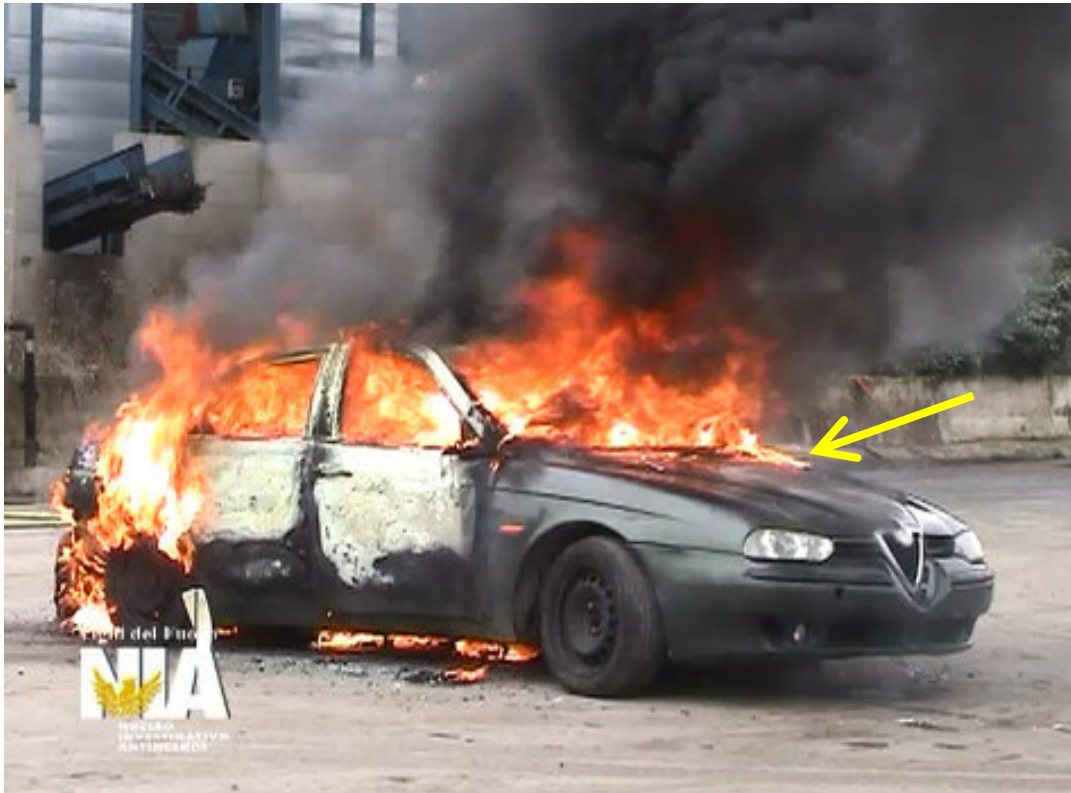
Fig. n.23 - Fermo immagine delle riprese video – incendio portello vano motore
