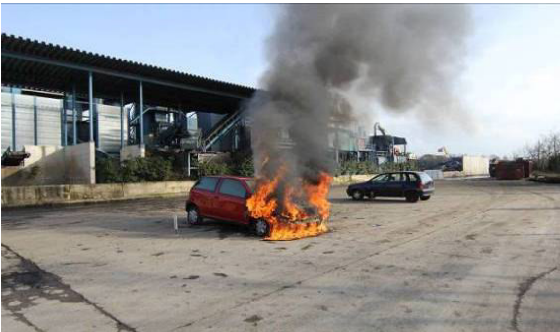
Fig. 60: L'incendio resta compartimentato nel vano motore
