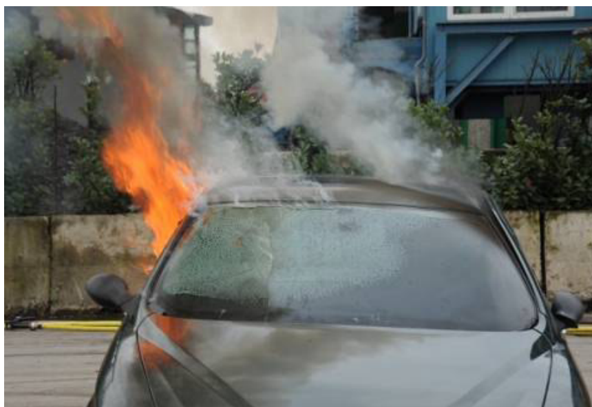
Fig. n.17 – Rottura del lunotto anteriore visibile anche dalla fuoriuscita del fumo
