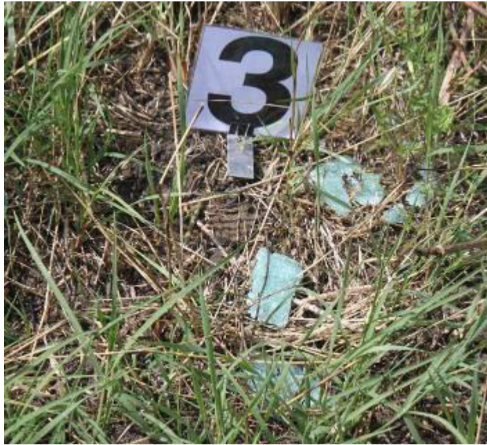
Fig. n. 14 – Frammenti di vetro rinvenuti a distanza dal luogo dell'incendio e privi del deposito di fuliggine
