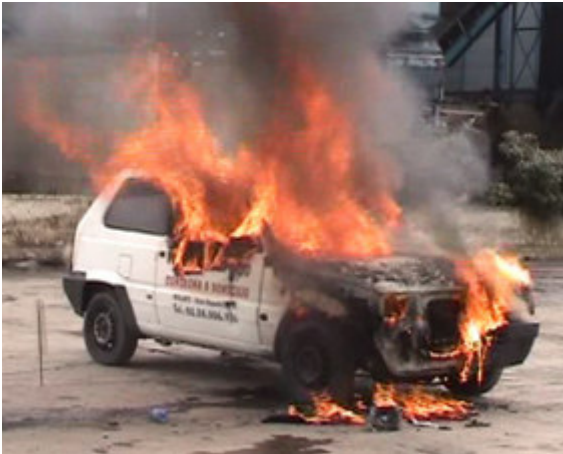
Fig. n.39 - Fermo immagini della ripresa video dopo circa 16'÷17' dall'inizio prova che illustrano la progressione dell'incendio sullo strato di verniciatura della portiera, dall'alto verso il basso
