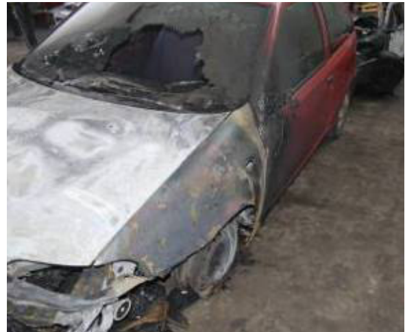
Fig. n.67 - Danno lato sinistro
